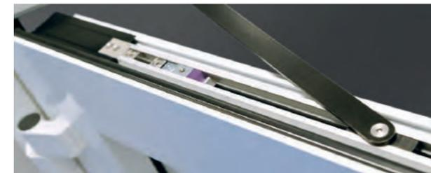
**Verdeckter Öffnungsbegrenzer** - Standard bei BFD, Optional bei GF und FD. Der Öffnungsbegrenzer wird verdeckt liegend verbaut bei einer Mindestflügelbreite von 830 mm. Er besitzt eine Rastfeststellung mit Endschlagdämpfung, zusätzlich ist die Haltekraft und der Öffnungswinkel bis zu 115° einstellbar.
