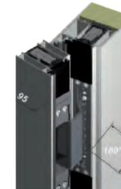
**Verdeckt liegende Türbänder** - Standard bei BFD, optional bei GF und FD. Die verdeckt liegenden Türbänder sind von außen „unsichtbar“. Damit der Türflügel bei Öffnung der Tür nicht mit dem Rahmen kollidieren kann, sollte der Öffnungswinkel (max. 100°) durch z.B. einen Öffnungsbegrenzer begrenzt werden.
